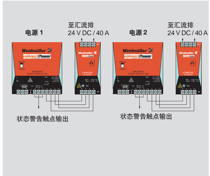
图(4)两台 40 A 电源并联
